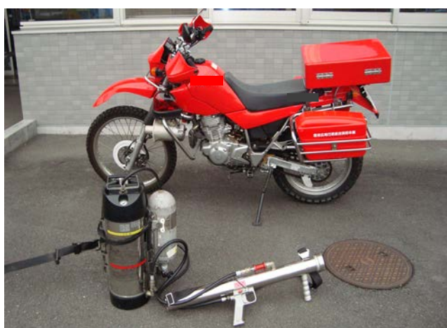
消防活動用バイク及び可搬式消火器具例
